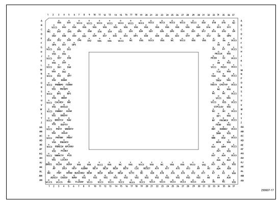
Figure 17. 320-Pin Socket 5
